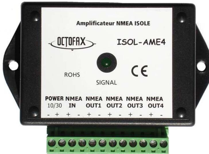
Cet appareil opto-isolé à l'entrée et à chaque sortie vous permet d'envoyer par exemple l'information NMEA du GPS vers plusieurs appareils (Centrale de navigation, Pilote automatique, VHF, Cartographie PC...) avec le maximum de sécurité. La diode LED visualise la présence du signal.
